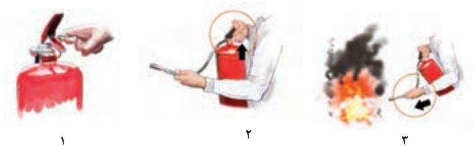
شکل ۳-۳- نحوه استفاده از کپسول آتش‌نشانی ۱
