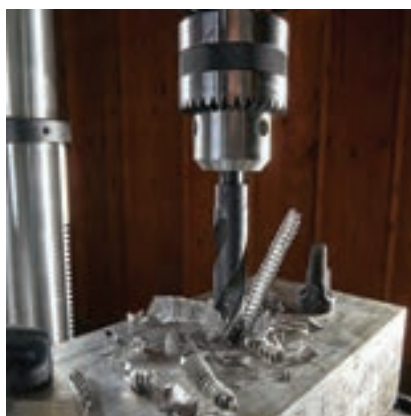
شکل ۳۰-۳- عملیات سوراخ کاری قبل از برقوکاری
