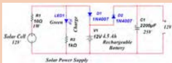
شکل ۱۸-۵- نقشه فنی مدار الکترونیکی برای تهیه طرح مدار چاپی
