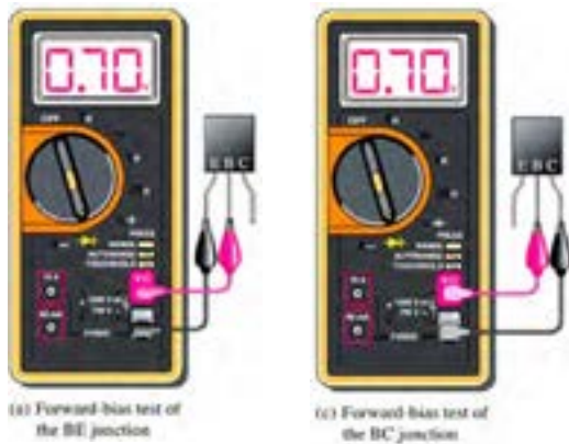
شکل ۴-۳- تشخیص پایه بیس ترانزیستور با مولتی‌متر دیجیتالی
