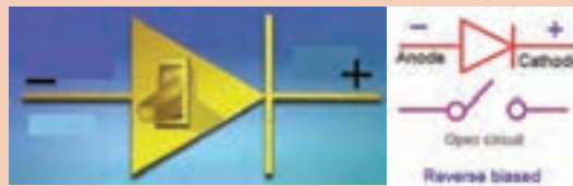
شکل ب ۳-۸- دیود ایده‌آل در بایاس مخالف
