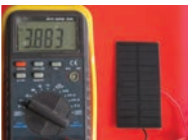
شکل ۳-۹۵- اندازه‌گیری ولتاژ سلول خورشیدی
