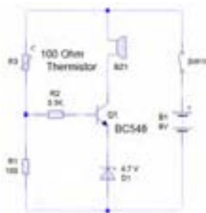
شکل ۲۴-۷- مدار حسگر دما
