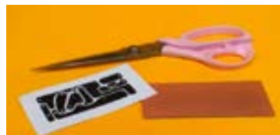
شکل ۷-۷- برش طرح مدار چاپی از کاغذ
