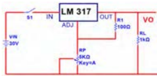
شکل ۸۲-۳- مدار آزمایش با آی سی رگولاتور متغیر
