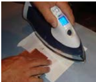
شکل ۹-۷- کشیدن اتو روی کاغذ و فیبر
