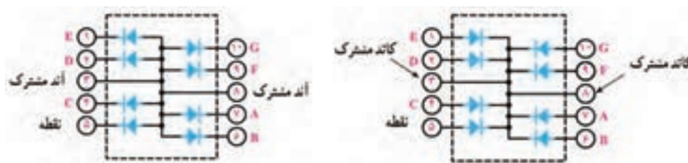
الف- مدار آند مشترک
