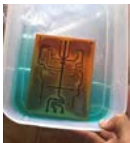
شکل ۱۶-۷- تکان دادن محلول برای خورده شدن مس اضافی فیبر
