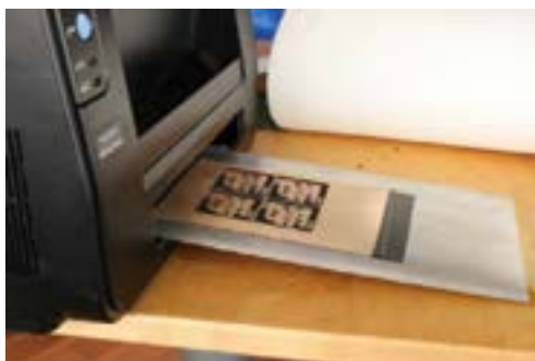
شکل ۷-۵- چاپ طرح مدار چاپی با دستگاه چاپ گر
