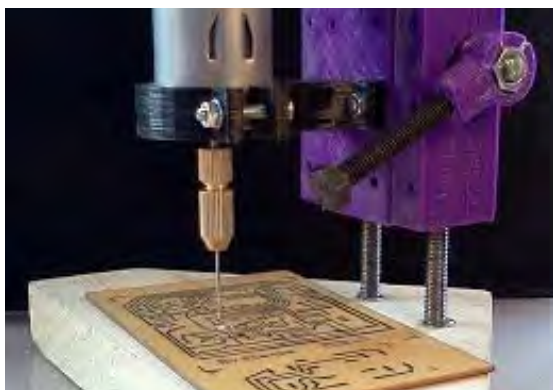
شکل ۱۸-۷- سوراخ کاری پایه قطعات با مته مناسب
