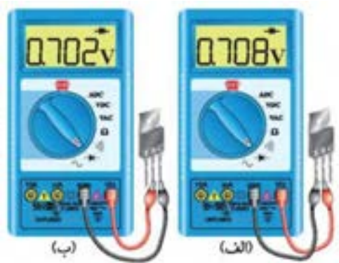
شکل ۴-۴ ولتاژ موافق کلکتور-بیس و امیتر-بیس
