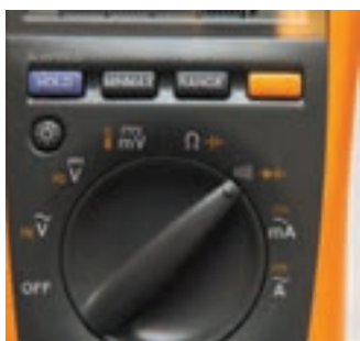
شکل ۳-۵- مولتی متر دیجیتالی در حالت آزمایش دیود
