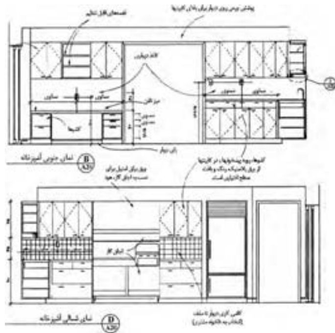
شکل ۲-۲۳۷. مقطع نمای آشپزخانه
