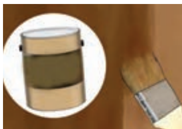
۵- آستر کردن دیوار با آستری (روغن الیف)
