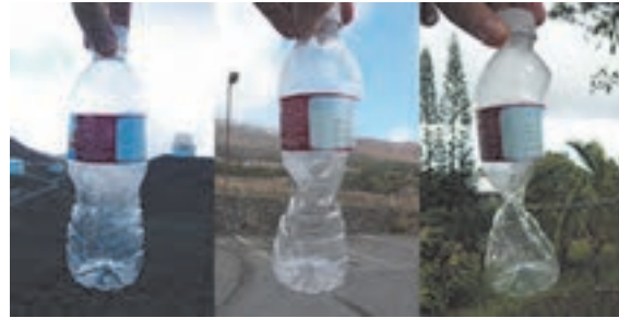
شکل ۴-۵ بطری خالی پلمب شده در ارتفاع ۲۷۰۰ و ۳۰۰ و ۴۳۰۰ متری از سطح دریا
