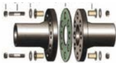
شکل ۳-۳۳ نحوه قرارگیری واشر آب‌بندی
