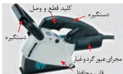
شکل ۲-۱۲ اجزاء دستگاه شیارزن
