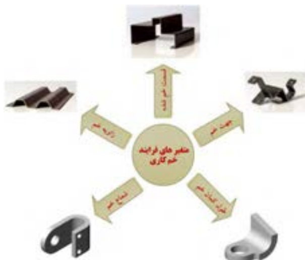
شکل ۲-۳ متغیرهای خم کاری
