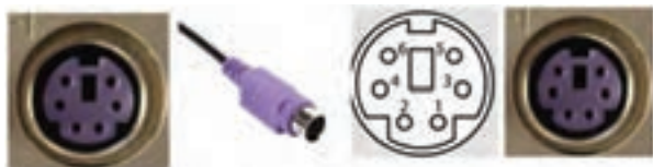
شکل ۹- رابط PS/2 صفحه کلید
