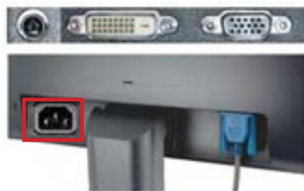
شکل ۴- محل اتصال کابل های صفحه نمایش
