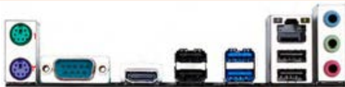
شکل ۸- درگاه‌های روی برد اصلی
