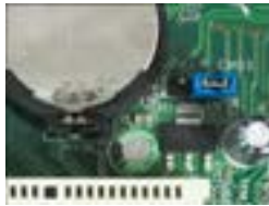
شکل ۱۴ - جامپر Clear CMOS
