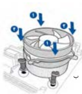
شکل ۳۷- نصب سیستم خنک‌کننده
