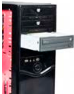
شکل ۵۰- قراردادن دیسک گردان نوری در کیس
