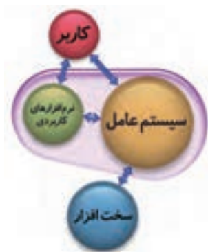
شکل ۱۹- ارتباط کاربر-نرم‌افزار کاربردی-سیستم‌عامل-سخت‌افزار
