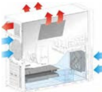
شکل ۳- تهویه کیس به وسیله فن‌ها
