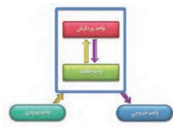
شکل ۱- نمودار سخت‌افزاری سیستم رایانه‌ای
