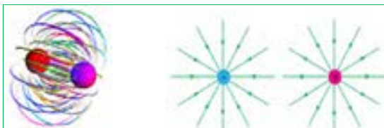
الف - جهت میدان الکتریکی در ذره باردار
