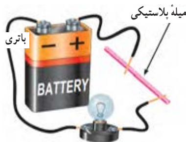
شکل ۲۰-۱ برقرار نشدن جریان الکتریکی در عایق
