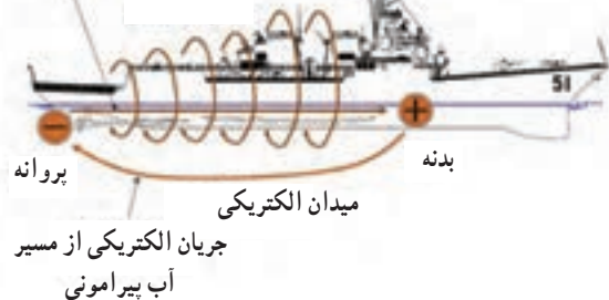
جریان الکتریکی از مسیر بدنه میدان مغناطیسی
