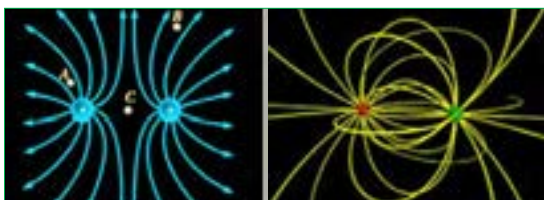
ب - میدان الکتریکی بین دو ذره باردار در کنار هم
