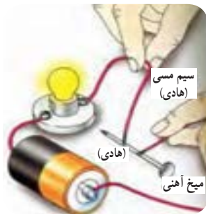
شکل ۱۹-۱- برقراری جریان الکتریکی در هادی
