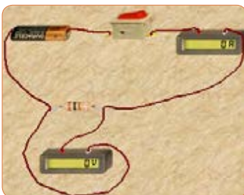
شکل ۲-۴۶- مدار با ولت متر و آمپر متر
