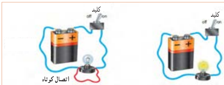
الف - مدار در حالت عادی (لامپ روشن) ب - مدار در حالت کوتاه (لامپ خاموش) عبور جریان بسیار زیاد است.
