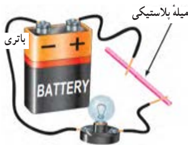
شکل ۲۰-۱ برقرار نشدن جریان الکتریکی در عایق
