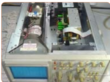
شکل ۴۰-۳- ساختمان داخلی یک نوع اسیلوسکوپ
