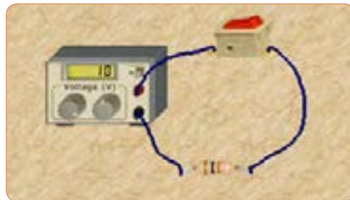
شکل ۲۱ - ۴ مدار آزمایش با مقاومت ۱۰۰ اهم
