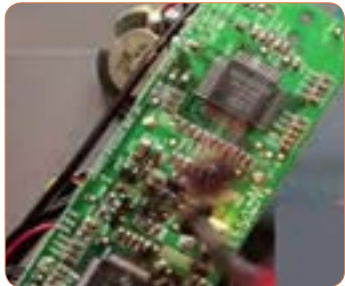
شکل ۴-۴ - قطعاتی از برد سوخته است.
