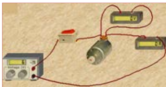
شکل ۵۲-۲- مدار عملی با ولت متر دو سر موتور
