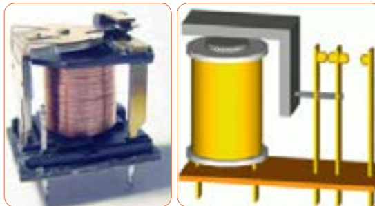
شکل ۳۴-۵. ساختمان داخلی دو نوع رله
