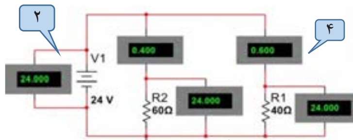
شکل ۷۰-۱- ترسیم مدار با ولت متر و آمپر متر
