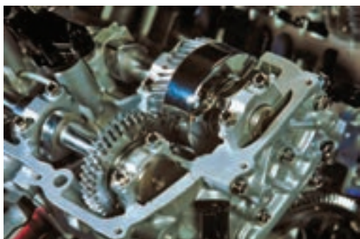
انتقال حرکت از میل لنگ به میل سوپاپ در موتورهای قدیمی انتقال حرکت از میل لنگ به میل سوپاپ هادر نمونه‌ای از موتورهای امروزی
