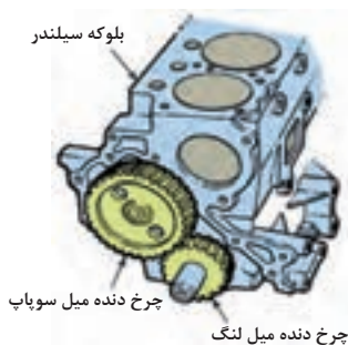
انتقال حرکت از میل لنگ به میل سوپاپ در موتورهای قدیمی انتقال حرکت از میل لنگ به میل سوپاپ هادر نمونه‌ای از موتورهای امروزی
