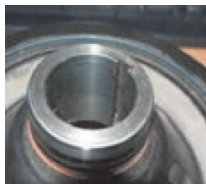
ساییده شدن محل قرارگیری کاسه نم
