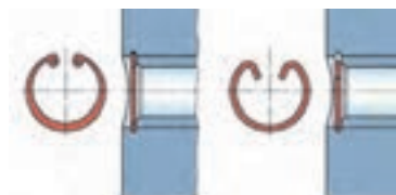
انواع خارهای به کار رفته جهت مانع از حرکت گژن پین
