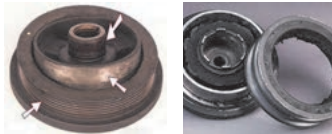
پاره شدن لاستیک میان دو حلقه
