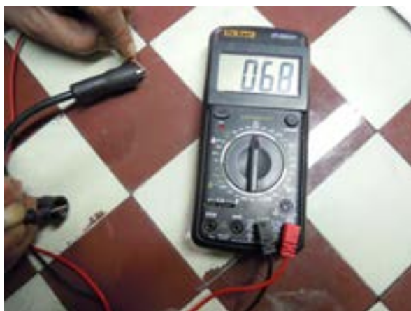
شکل ۴۳-۸- تست اهمی وایر شمع
