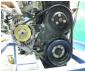
۳- کاور جلو موتور و پولی میل لنگ باز شود.
