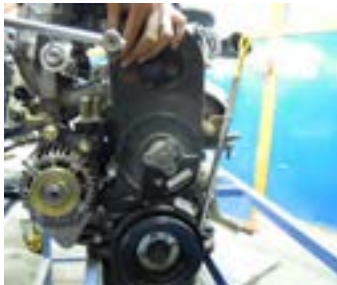
۲- تسمه تجهیزات جانبی باز شود.
