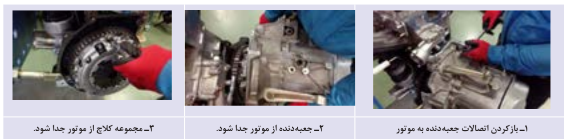
شکل ۹-۱۲- روش پیاده‌سازی مجموعه جعبه‌دنده و دستگاه کلاچ از روی موتور محرک جلو
