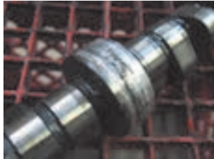
خرابی تکیه‌گاه میل سوپاپ
