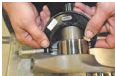
مرحله ۲: اندازه‌گیری قطر لنگ یا محور ثابت
