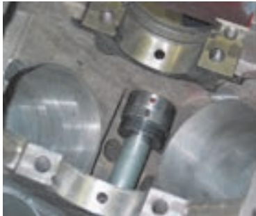
تعویض بوش‌های میل سوپاپ
