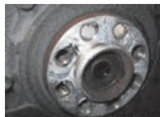
الف) خرابی جای پیچ فلاپویل بر روی میل لنگ
