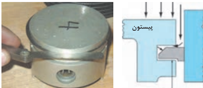
ب) کنترل خلاصی رینگ و پیستون نو
