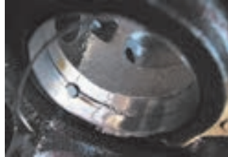
خرابی یاتاقان میل سوپاپ
