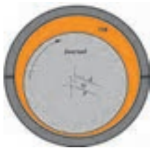
الف) لایه روغن بین یاتاقان و میل لنگ
