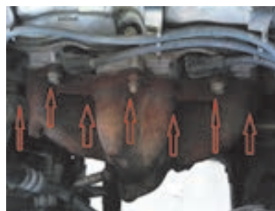
تصویر نشتی بین مانیفولد و لوله اگزوز
