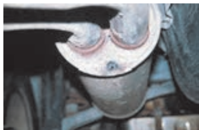
تصویر سوراخ شدن کاتالیست
