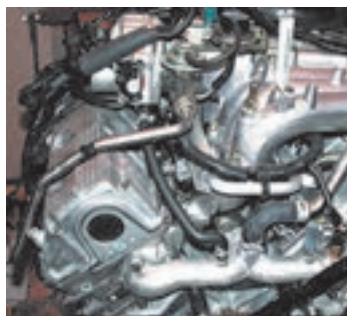
محل نصب EGR روی موتور خودرو
