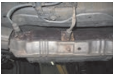
محل نصب حسگر اکسیژن روی مبدل کاتالیست
