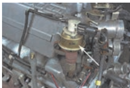
محل نصب EGR روی موتور خودرو
