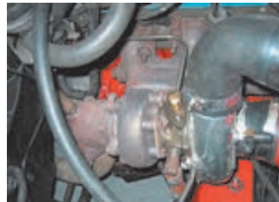
محل نصب توربو شارژر روی موتور
