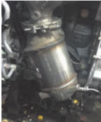
محل نصب مانیفولد خروجی و کاتالیست روی موتور خودرو مجموعه مانیفولد خروجی و کاتالیست شکل ۳-۵ مبدل کاتالیست یکپارچه
