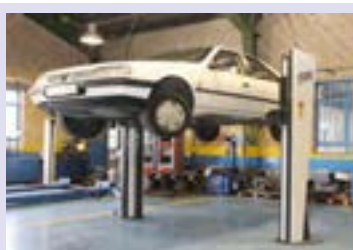
۲- پس از رسیدن موتور به دمای طبیعی آن را با رعایت ایمنی رو چاله سرویس و با جک بالا بردارید. مستقر کنید.
