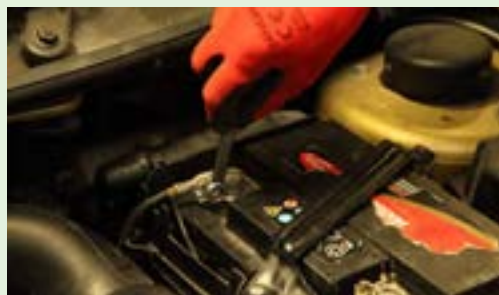
شکل ۱۹-۲- جدا کردن سر باتری
