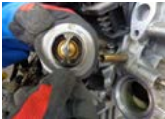
۶- ترموستات به صورت صحیح در محل خود قرار گیرد. (سوپاپ حباب‌گیر به سمت بالا)
