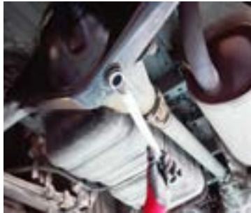
۳- پیچ تخلیه روغن دیفرانسیل باز شود ۴- مخزن جمع آوری روغن مستعمل زیر خودرو قرار گیرد.
