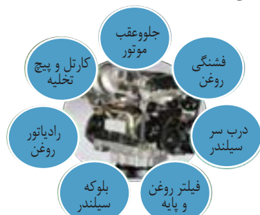
شکل ۵-۳- نقاط احتمالی بروز نشستی موتور
