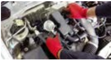
۶- مقدار فشار کمپرس تک تک سیلندرها قرائت و ثبت و مقایسه گردد.
