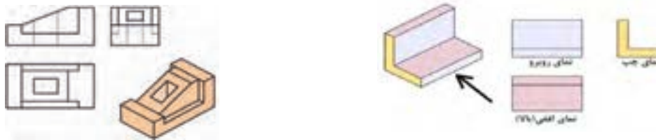
شکل ۸-۵ دو نمونه نقشه سه نما
