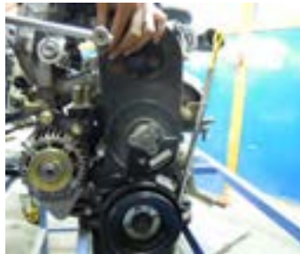
۲- تسمه تجهیزات جانبی باز شود.
