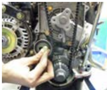
۶- تسمه سفت کن جدید به صورت آزاد(شل) نصب گردد.
