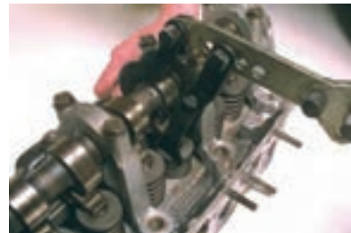
استفاده از فنر سوپاپ جمع کن اهرمی مخصوص در برخی از سرسیلندرها
