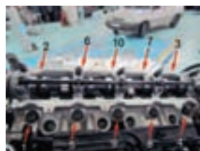
ترتیب باز کردن پیچ های سرسیلندر
