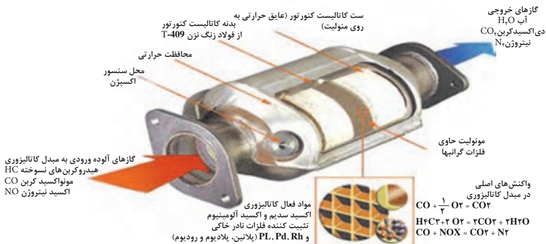
شکل ۱۱-۳ بخش‌های تشکیل دهنده یک مبدل کاتالیست
