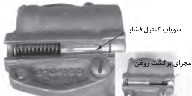
بررسی سلامت اجزای سوپاپ کنترل فشار
