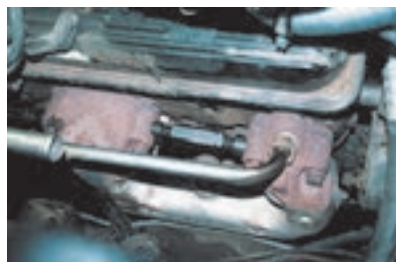
تصویر نشستی دود بین مانیفولد و سرسیلندر
