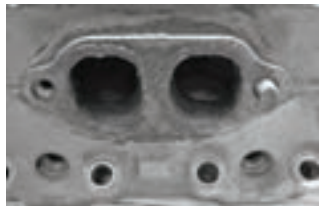
بریدن پیچ اتصال مانیفولد دود داخل سرسیلندر
