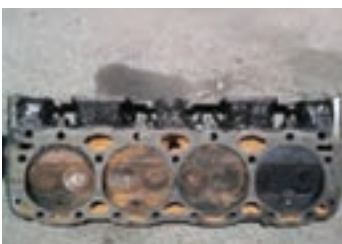
ورود مایع خنک کننده به سرسیلندر
