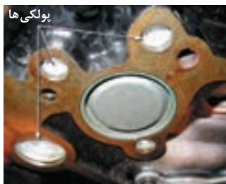
پولکی‌های نصب شده
