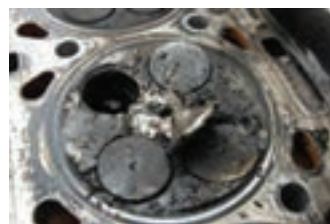
ذوب شدن سوپاپ
