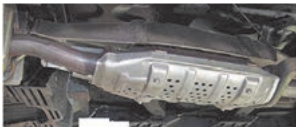
شکل ۲۷-۳ محل نصب سپر حرارتی در سیستم اگزوز
