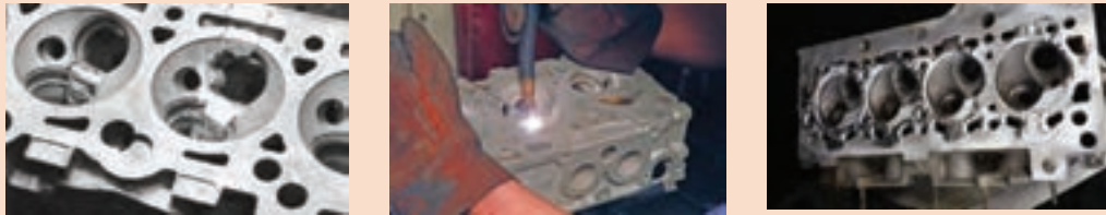
جوشکاری محل‌های خورده و یا ذوب شده سرسیلندر
