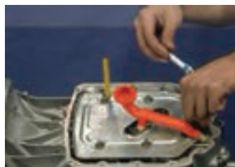
باز کردن صافی روغن ورودی به پمپ
