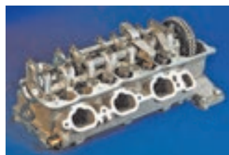
محل نصب مانیفولد خروجی روی
