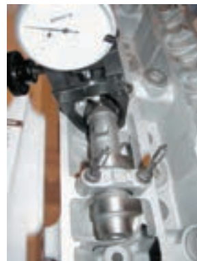
اندازه‌گیری مستقیم ارتفاع بادامک‌ها توسط ساعت اندازه‌گیر مخصوص روی سرسیلندر
