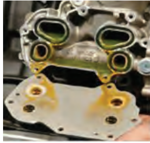
نصب درپوش خنک کن روغن
