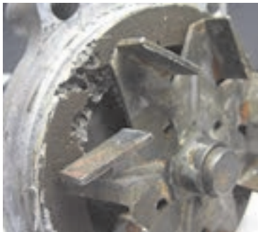
خرابی بلبرینگ و خوردگی داخلی
