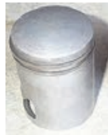
الف) پیستون قدیمی با وزن بیشتر
