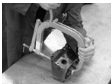
استفاده از فنر سوپاپ جمع کن دستی
