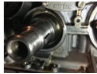
بازکردن چرخ دنده سر میل لنگ
