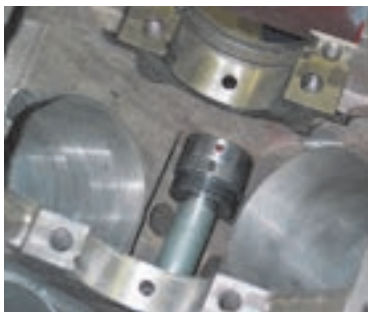
تعویض بوش‌های میل سوپاپ
