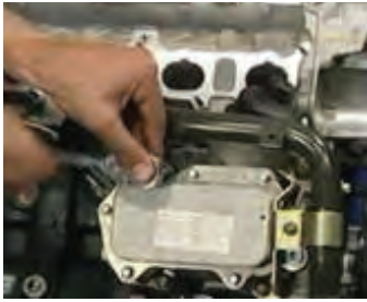
نصب خنک کن روغن بر روی موتور
