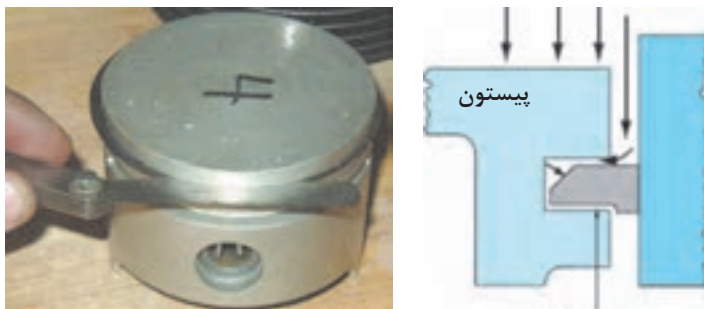
ب) کنترل خلاصی رینگ و پیستون نو
