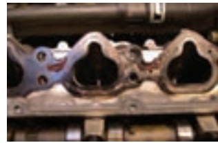
آثار نشتی مانیفولد دود روی سرسیلندر
