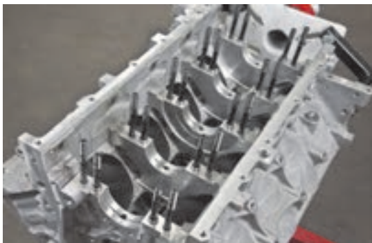
شکل ۲۹-۲ پیچ‌های اتصال کپه یاتاقان‌ها و محفظه لنگ
