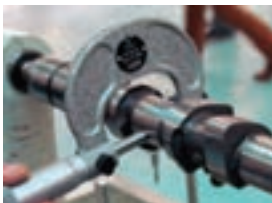
اندازه‌گیری ارتفاع بادامک پس از باز کردن میل سوپاپ
