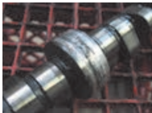
خرابی تکیه‌گاه میل سوپاپ
