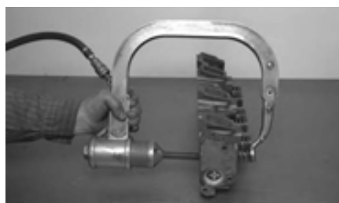
استفاده از فنر سوپاپ جمع کن پنوماتیکی
