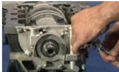
باز کردن پیچ های پمپ روغن
