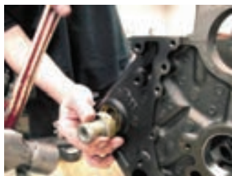
ابزار مخصوص و روش نصب پولکی
