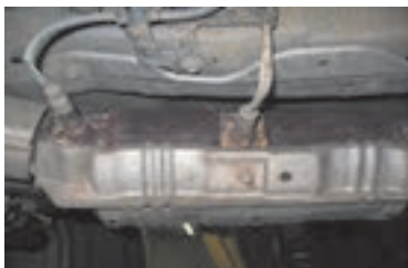
محل نصب حسگر اکسیژن روی میدل کاتالیست
