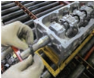
شکل ۱-۵۵ نحوه تعویض کاسه نمد میل سوپاپ با استفاده از ابزار مخصوص
