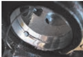
خرابی یاتاقان میل سوپاپ
