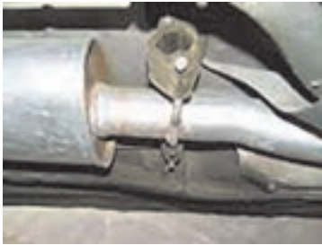
بررسی بست‌های نگهدارنده سیستم اگزوز
