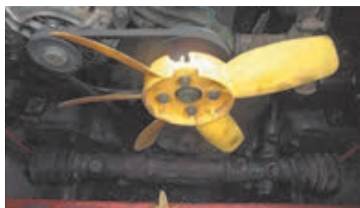
وجود شکستگی یا ترک پره‌ها
