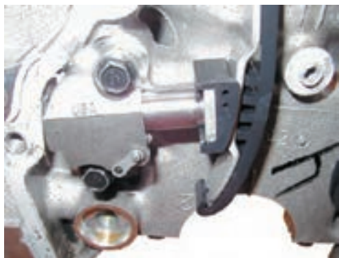
تجهیزات زنجیر سفت کن هیدرولیکی
