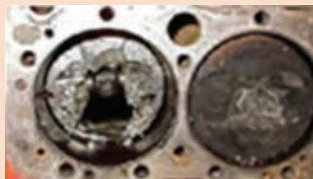
ذوب شدن پیستون
