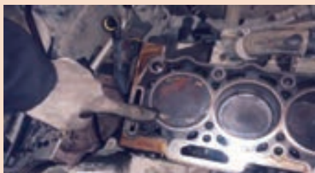
بر خورد سوپاپ‌ها به سر پیستون
