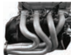
کنترل مانیفولد خروجی (فولادی)
