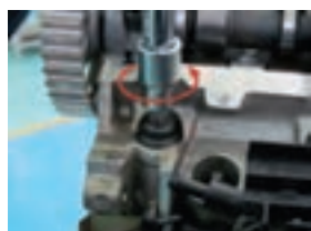
جهت باز کردن پیچ های سرسیلندر
