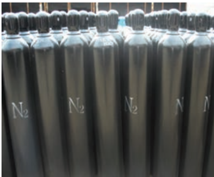
شکل ۲۱- کپسول گاز ازت ( N_2 )
