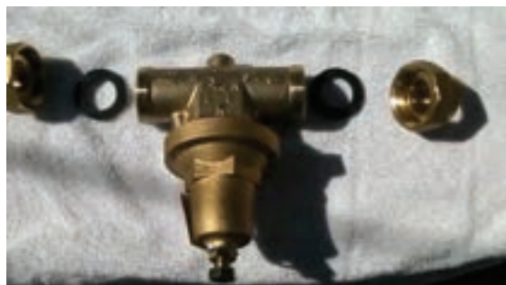
شکل ۱۹- شیر فشارشکن دیافراگمی
