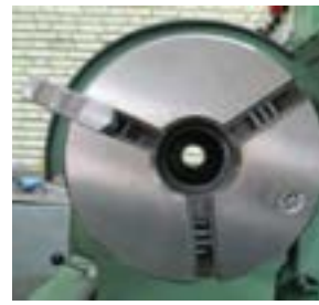
الف: استقرار فک روی پیچ ارشمیدس
