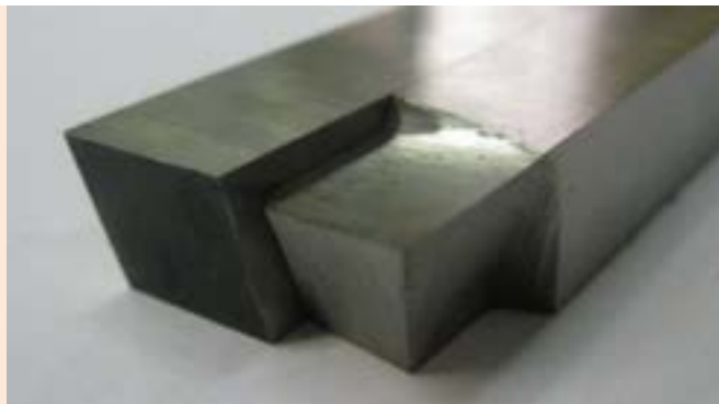
شکل ۲-۲۱: رنده قبل و بعد تیز کردن
