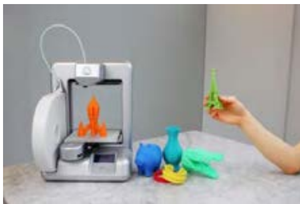
ب: قطعات ساخته‌شده به روش لایه‌نشانی مذاب
