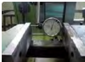
تنظیم گیره به کمک ساعت اندازه گیری
