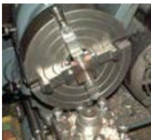
ج: بستن قطعه با مقطع مستطیل در صفحه نظام با فک های تکرو
