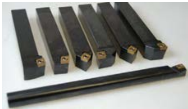
شکل ۲-۲۰: تیغچه بسته شده در نگه دارنده (هولدر)
