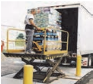
(بارگیری پک‌ها به کمک چرخ دستی و بالابر قیچی با قابلیت تنظیم ارتفاع)
