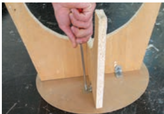
شکل ۶۷- مراحل مونتاژ چهارپایه
