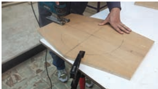
شکل ۴۹- محکم بستن قطعه کار
