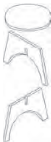
شکل ۳۰- نقشه انفجاری چهارپایه
