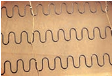
شکل ۷۴ - فنر زیگزاگ (سینوسی)
