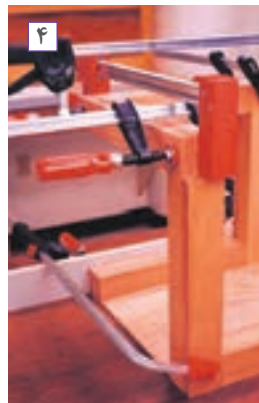
شکل ۲۷- مراحل مونتاژ میز جلوی مبل
