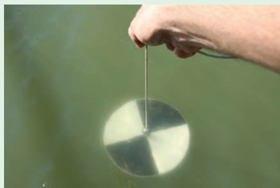
اندازه‌گیری کدورت آب محل پرورش ماهی
