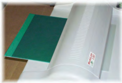
شکل ۳-۱۶- خروج فیبر از لمینتور
