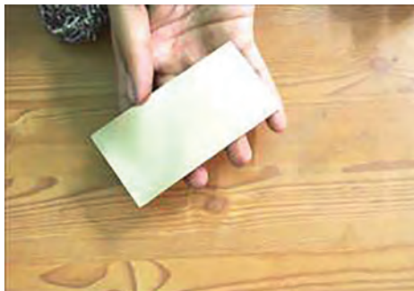
شکل ۳-۱۰- فیبر مسی تمیز شده
