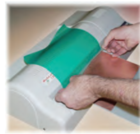
شکل ۱۴-۳ قرار دادن فیبر در لمینتور
