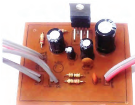
شکل ۴-۹۰- مدار مونتاژ شده تقویت کننده
