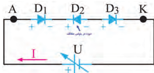
شکل ۷-۴ دیود چهار لایه در بایاس موافق
