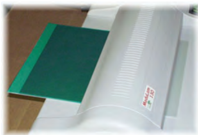
شکل ۱۶-۳ خروج فیبر از لمینتور
