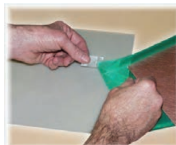
شکل ۳-۱۱- جدا کردن روکش لمینت
