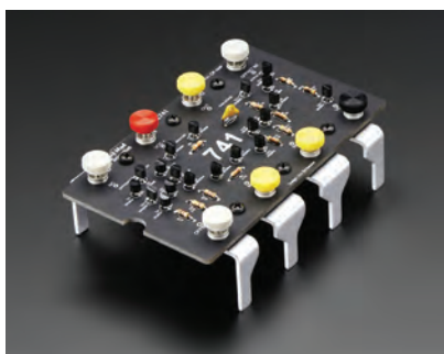
شکل ۵۴-۴ مدار داخلی آی سی ۷۴۱ با قطعات مجزا
