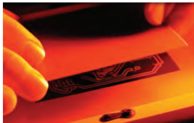
شکل ۳-۲۱- قرار دادن فیبر روی نقشه
