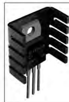
شکل ۷-۶۸ ترایاک متصل شده به گرماگیر
