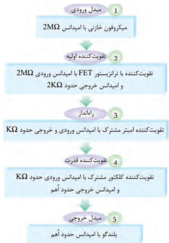
شکل ۴-۳- بلوک دیاگرام اتصال چند طبقه تقویت‌کننده به‌هم
