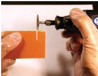
شکل ۸-۳- بریدن فیبر با مینی فرز
