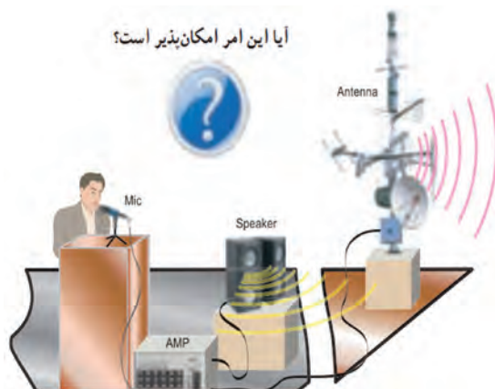
شکل ۶-۴۷ تبدیل امواج صوتی به امواج الکترومغناطیس
