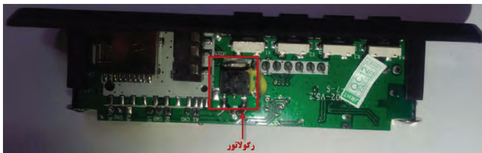
شکل ۵-۸- برد MP۳ با رگولاتور ۷۸۰۵ داخلی
