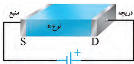
شکل ۴-۱۷- نیمه‌هادی با ناخالصی N به عنوان کانال
