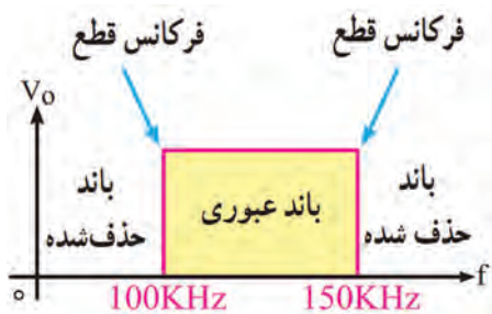
شکل ۵-۶ منحنی پاسخ فرکانسی فیلتر ایده‌آل
