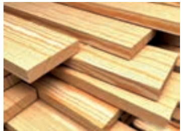
تخته‌های مورد استفاده در قالب‌بندی چوبی:
