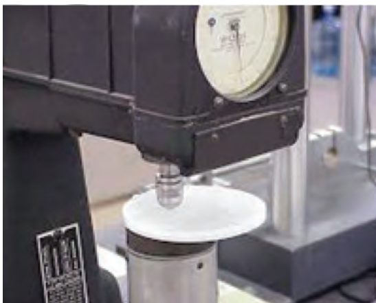
شکل ۱۹- روش‌های دستی و دستگاهی تعیین سختی
