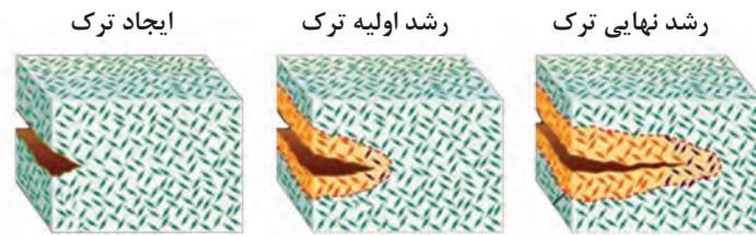
شکل ۲۲- گسترش ترک و مقاومت ماده در برابر آن (چقرمگی)
