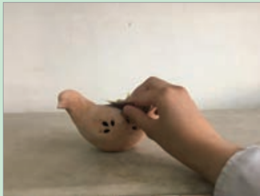
پرداخت بدنهٔ شکل‌دهی شده به روش شستی
