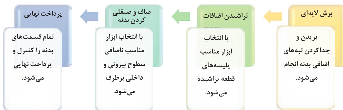
شکل ۹- مراحل پرداخت قطعه پس از شکل‌دهی
