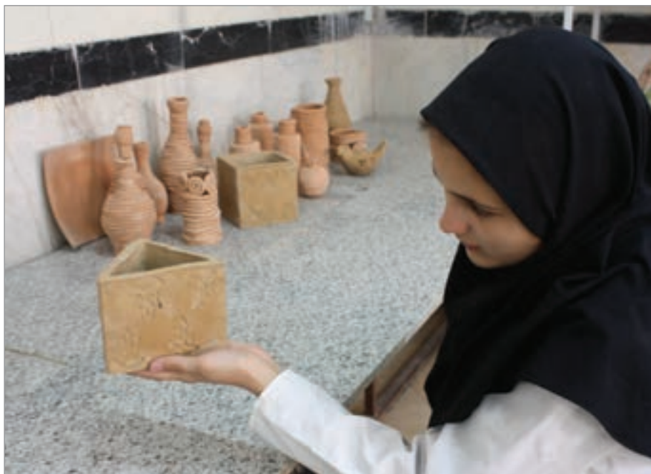
شکل ۱۴- کنترل چشمی فراورده های سرامیکی تولید شده به روش دستی
