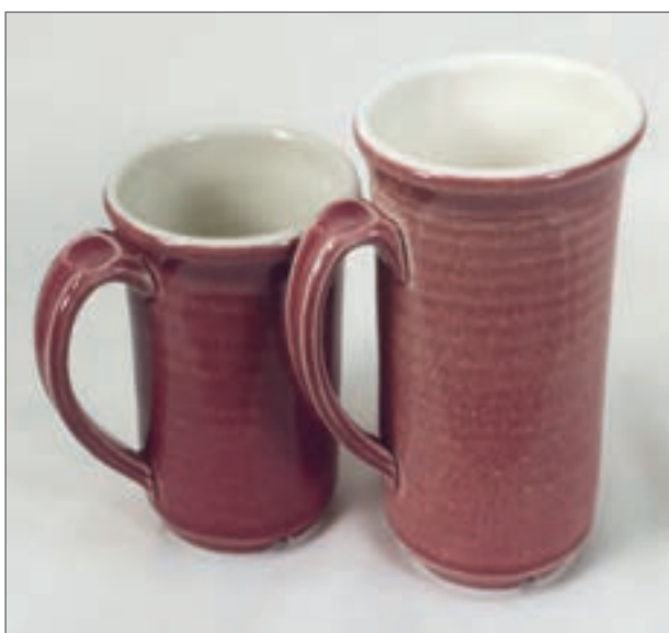
شکل ۲۶- لعاب با دمای پخت نامناسب
