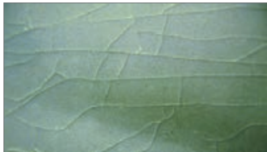
شکل ۲۷- عیب ترک برداشتن لعاب
