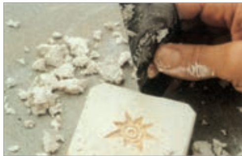
شکل ۱۳- تراشیدن طرح بر روی قالب گچی
