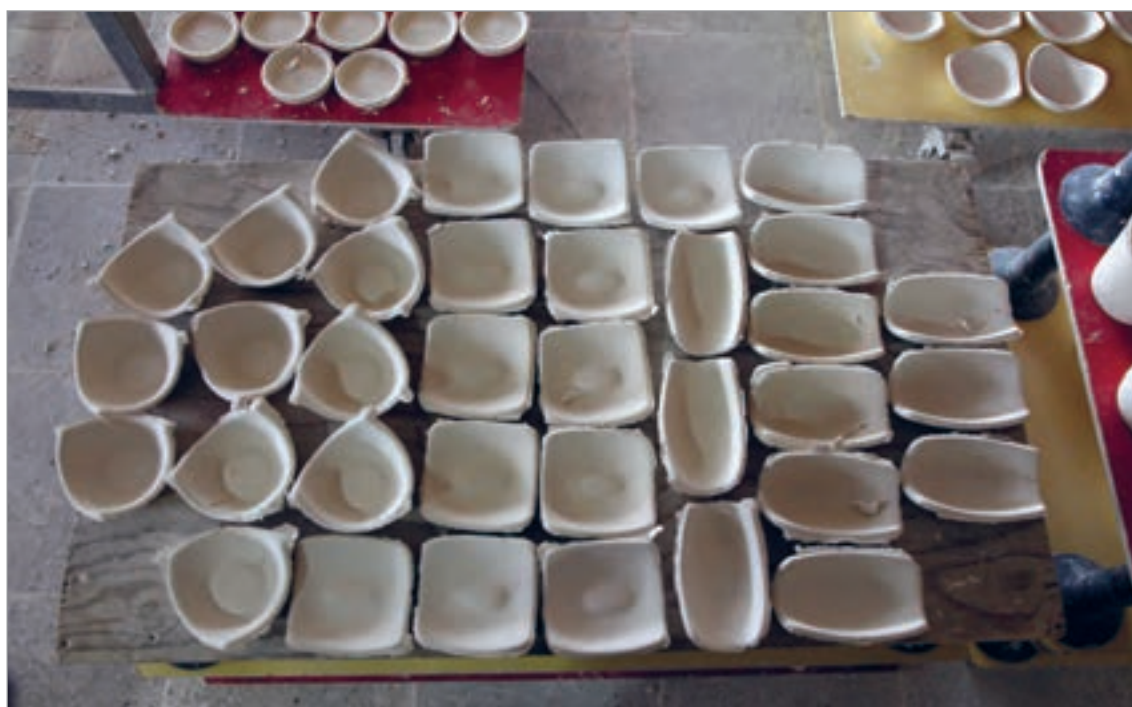
شکل ۱۱- ناهمواری و زوائد روی سطح قطعات مختلف سرامیکی
