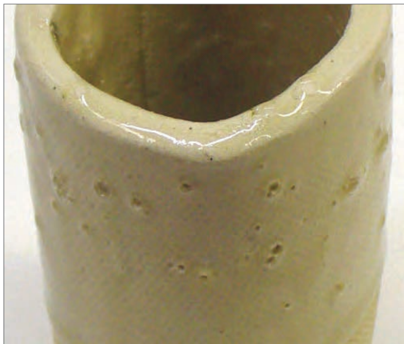
شکل ۳۵- عیب تاول زدن لعاب
