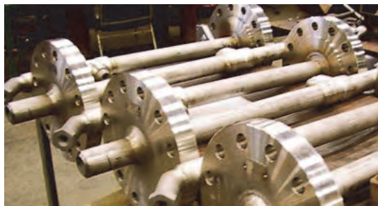
شکل ۳۴- لنس‌های متصل به لوله‌های اسپری درایر
