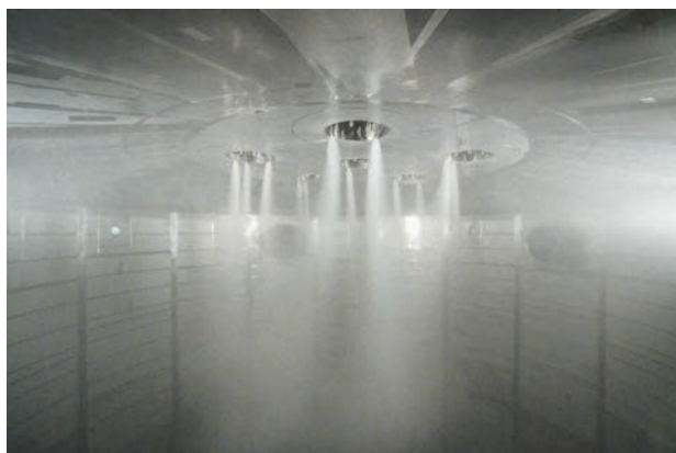
شکل ۲۷- چیدمان چندین افشانک نازلی در یک اسپری درایر
