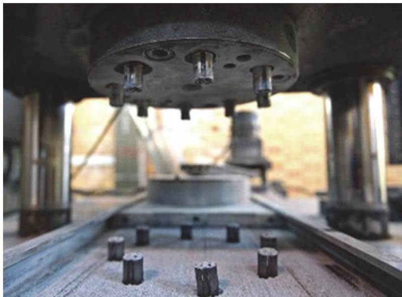
شکل ۱۱- پرس با قالب حاوی ۸ حفره
