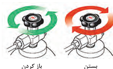
شکل ۸-۵. جهت باز و بستن شیر کپسول گازی
