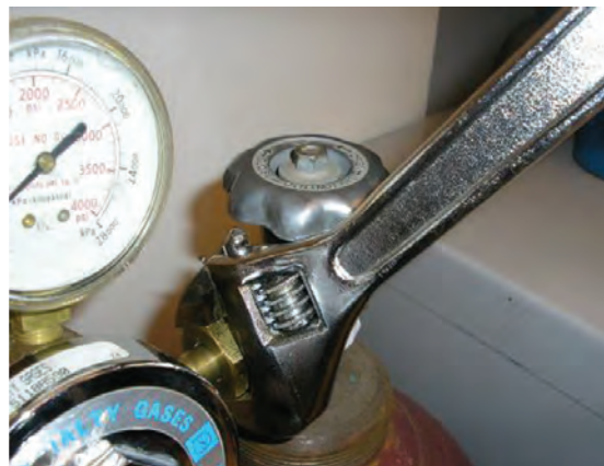
نحوه بستن رگولاتور به کپسول
