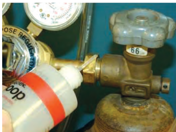
تست نشتی بعد از بستن رگولاتور
