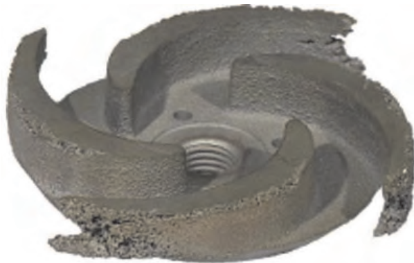
شکل ۱۸-۳ آسیب‌دیدگی پروانه پمپ در اثر پدیده کاویتاسیون
