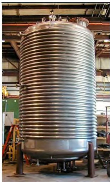
شکل ۴-۵ رآکتور ناپیوسته با سیستم حرارتی کویل
