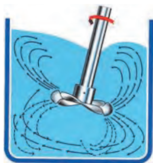
شکل ۲۷-۳ قرار دادن همزن خارج از مرکز و افزایش آشفته‌گی
