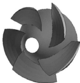
شکل ۹-۳ پروانه با جریان مختلط
