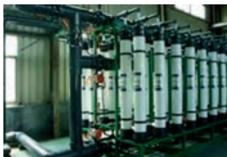
شکل ۱۰- نمایی ساده و واقعی از فرایند اولترافیلتراسیون
