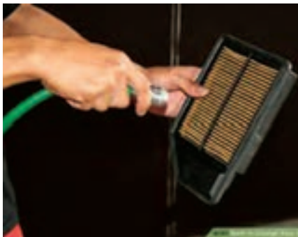
شکل ۳۲- چگونه تمیز کردن فیلتر با فشار هوا و آب
