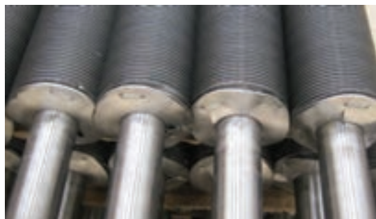
شکل ۲۶- لوله‌های پره‌دار در خنک‌کننده‌های هوایی
