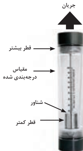
شکل ۷ - یک نمونه روتامتر معمولی
