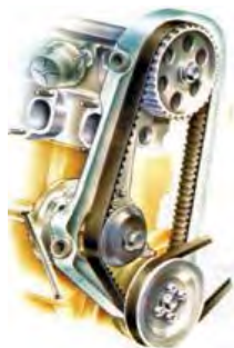
شکل ۲۸-۵ کاربرد چرخ و تسمه در موتور خودرو
