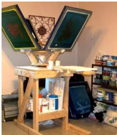
شکل ۴-۷ ماشین چاپ روی لباس ساخته شده با چوب و وسایل ساده
