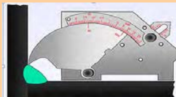
شکل ۱۲-۳- اندازه ساق جوش
