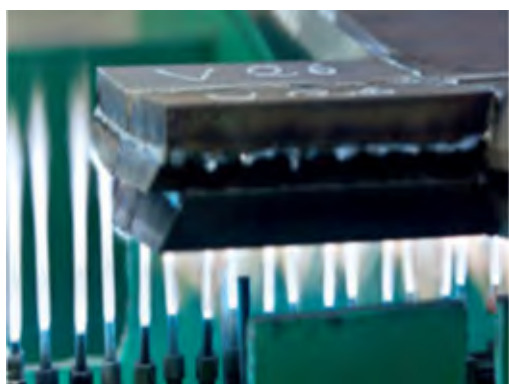
استفاده از شعله گاز جهت کنترل پیش‌گرم یا پس‌گرم
