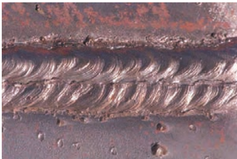
شکل ۴۰-۱: اندازه گرده جوش در پاس پوششی
