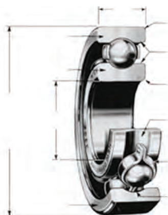
شکل ۵- ساختمان و اجزای بلبرینگ
