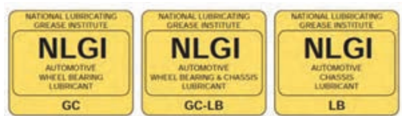
شکل ۱۱- برخی نمادهای گریس مورد استفاده در خودرو
