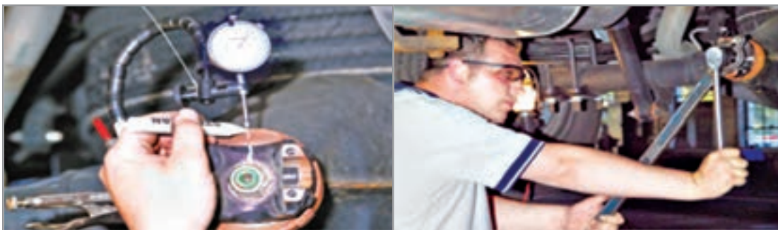
شکل ۲۵-۳- کنترل لنگی فلانچ و گشتاور سنجی مهره مرکزی دیفرانسیل
