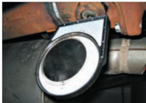
شکل ۱۳-۳ روش استفاده از زاویه سنج میل گاردان
