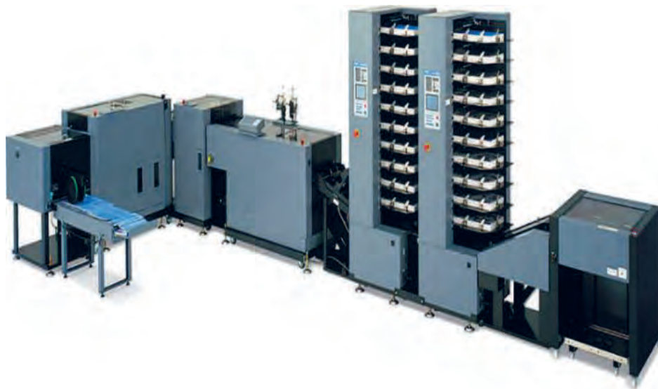
شکل ۶۸ - ماشین ترتیب عمودی با دو ایستگاه
