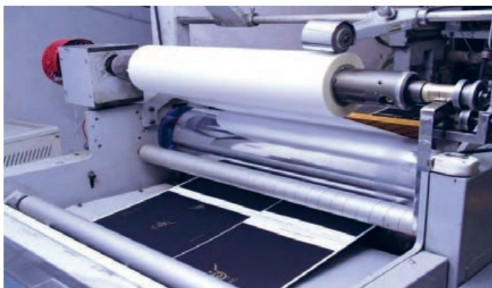
شکل ۳۲- تابگیر و تنظیم آن
