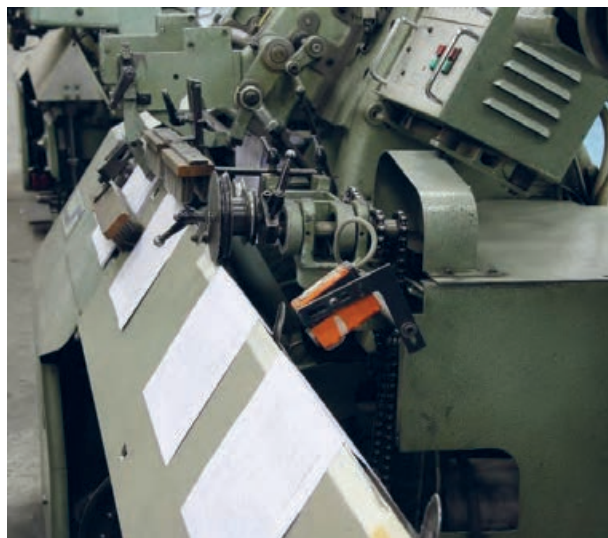
شکل ۲۴- صفحه انتقال دهنده فرم و قطعات آن
