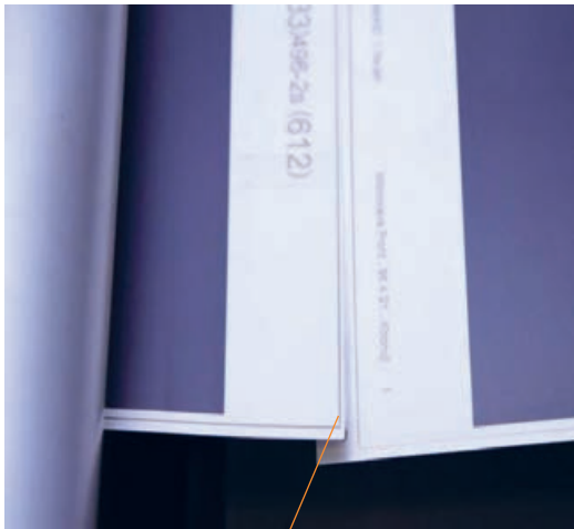
شکل ۳۵ - اورلب کارچاپی و درجه تنظیم آن
