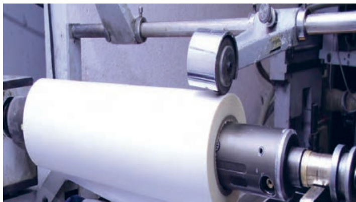
شکل ۳۶- پرفراژ دستگاه و تنظیم آن
