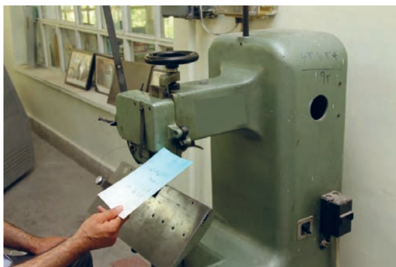
شکل ۳۸- تنظیم‌کننده ضخامت بلوک و طول مفتول
