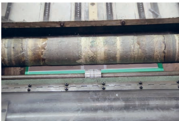
شکل ۵۳- صاف کردن پوشش‌های پرس شده
