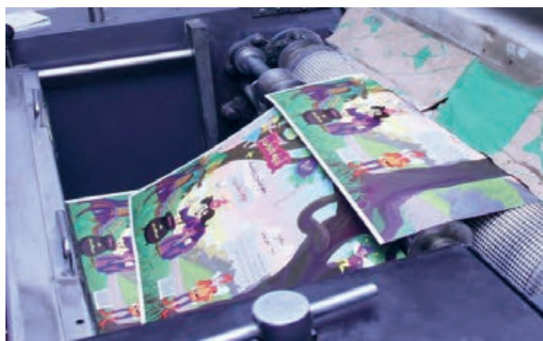
شکل ۱۴- تنظیم قسمت تحویل دستگاه ورنی زنی اسکرین
