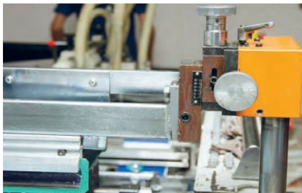
شکل ۱۳- چگونگی تنظیم فشار لبه اسکوییچی
