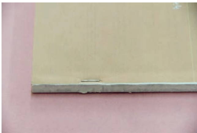
شکل ۱۶- رعایت فاصله مناسب مفتول تا انتهای عطف
