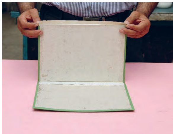
شکل ۴۴- برگرداندن دورتادور پوشش به داخل جلد
