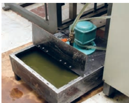
شکل ۲۰- مخزن ورنی و سیستم ورنی‌زنی
