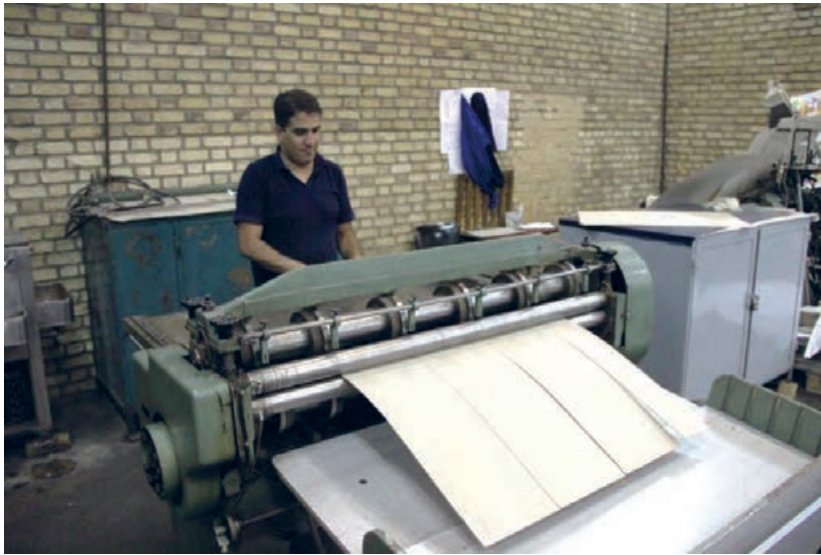
شکل ۴۶- برش لت‌های جلد با دستگاه مقوایر
