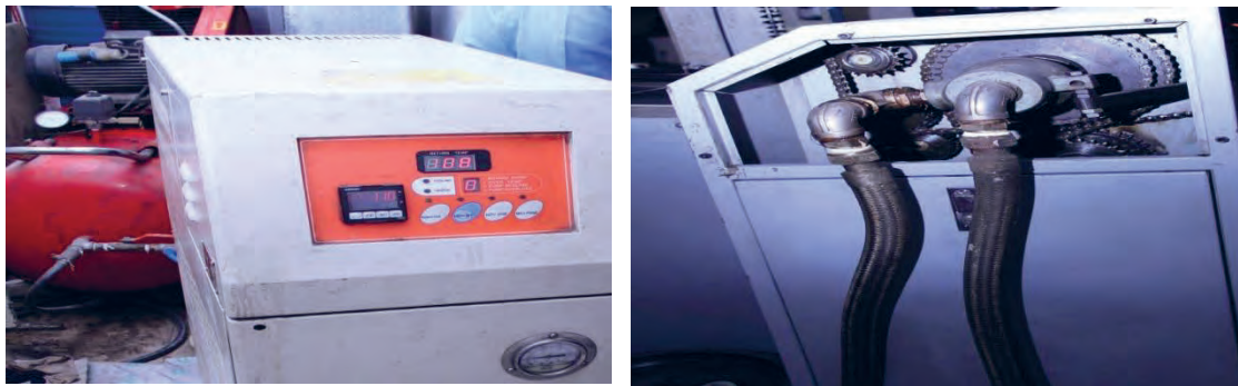
شکل ۲۷- سیستم گرمایشی سیلندر فشار
