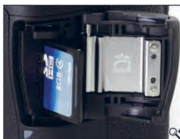
محل نصب کارت حافظه بر روی دوربین
