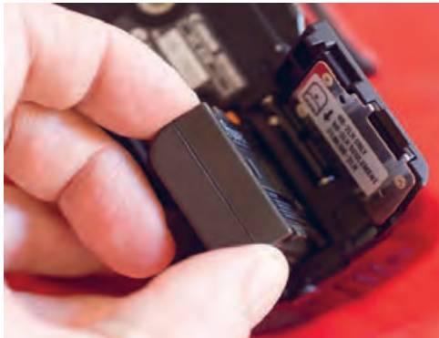
شیوه صحیح نصب باتری دوربین عکاسی
