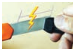
شکل ۱۳-۱- خطر در شکستن تیغه و پرتاب شدن قطعات آن به طرف انسان
