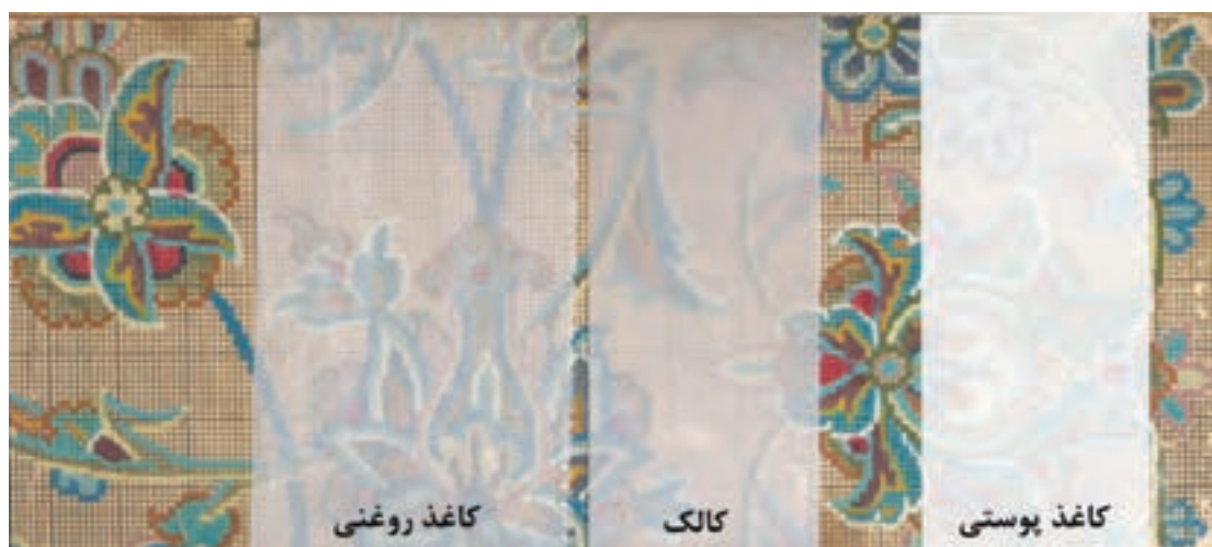
شکل ۵۰-۱- مقایسه میزان شفافیت کاغذهای پوستی، کالک و روغنی نسبت به یکدیگر
