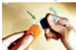
شکل ۱-۱۱- روش شکستن تیغه کاتر
