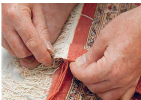
تصویر ۲۹- وارد کردن سوزن در رج بعدی ▲
