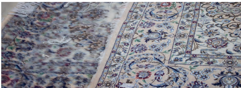
تصویر ۱- نمونه قالی، پیش و پس از پرداخت ▲
