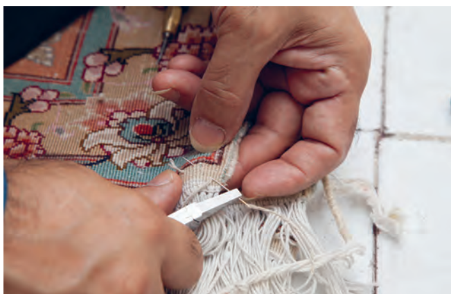
تصویر ۴۹- مراحل اتصال قیطان به لبه قالی ▲
