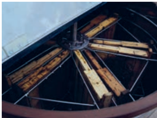
دستگاه اکستراکتور شعاعی و تماسی
