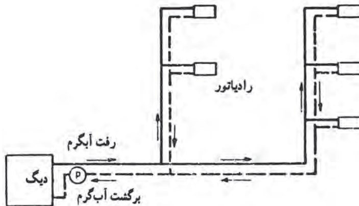
▲ شکل ۳-۹- حرارت مرکزی با آب گرم
